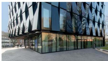
In die Fassade des Blauhauses wurden PV-Module integriert.
